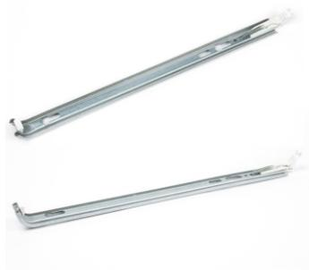
Кронштейн УК применяется для настенного монтажа стальных панельных радиаторов LEMAX Premium типов 21 С (VC), 22 С (VC), 33 С (VC). Высота кронштейна определяется высотой монтируемого радиатора. Изготавливается из оцинкованного листа ГОСТ 14918-80 толщиной 1,5 мм, конструктивный элемент, удерживающий верхнюю часть радиатора, выкрашен белой краской EcoPolifix RAL 9016.
