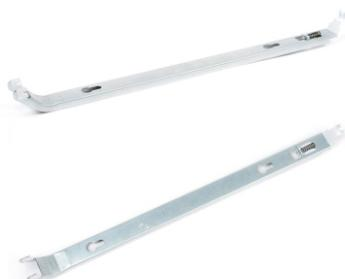
Кронштейн К 17.3 применяется для настенного монтажа стальных панельных радиаторов LEMAX Premium типов 21 С (VC), 22 С (VC), 33 С (VC). Высота кронштейна определяется высотой монтируемого радиатора. Изготавливается из оцинкованного листа ГОСТ 14918-80 толщиной 1,5 мм, конструктивный элемент, удерживающий верхнюю часть радиатора, выкрашен белой краской EcoPolifix RAL 9016.
